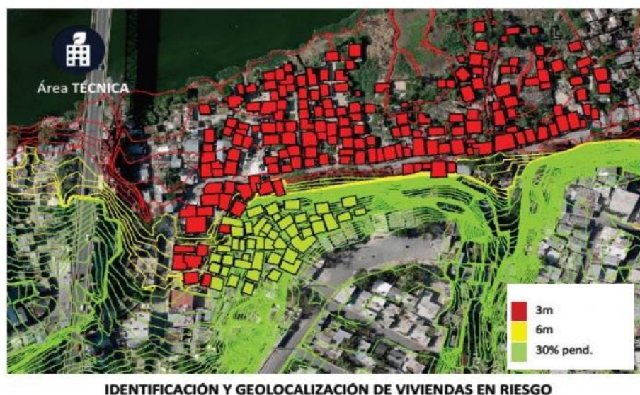
Ilustración 19: Identificación de viviendas en riesgo. La Barquita, Santo Domingo. Fuente: INCOCERCA
