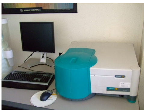
Figura 12. Espectrofotómetro de fluorescencia CARY ECLIPSE o Fluorímetro Se utilizó para este experimento, una sonda fluorescente; en concreto, el Prodan (6-propionil-2-dimetilamino-naftaleno), cuya estructura se representa en la Figura 13 :
