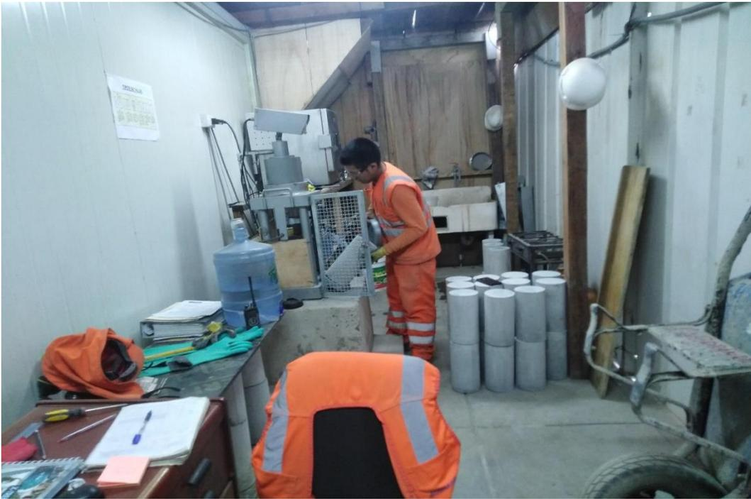
Foto 16. Control de resistencia de la rotura de probetas
