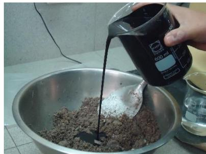
**Figura 20:** Colocación de Emulsión Asfáltica.
