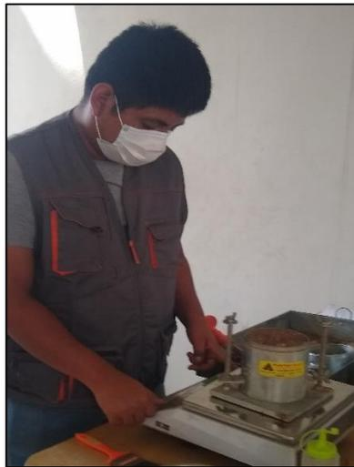
**Figura 19:** Pesando el Proctor más el suelo compactado.
