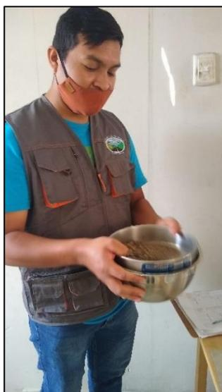
**Figura 15:** Tamizado en la malla N° 40 de la muestra.
