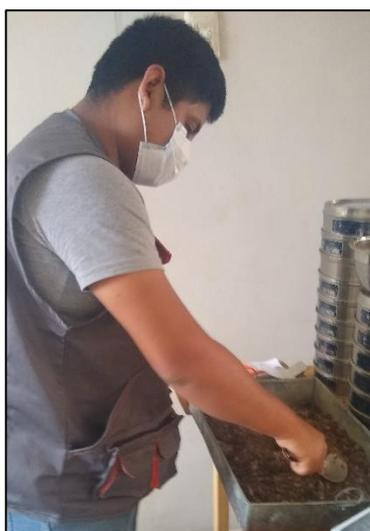
**Figura 17:** Mezcla de la Muestra con un porcentaje de Agua.
