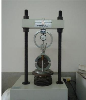
**Figura 21:** Ensayo Marshall.
