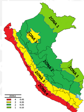
Figura 4: Zonas sísmicas según la Norma E.030
