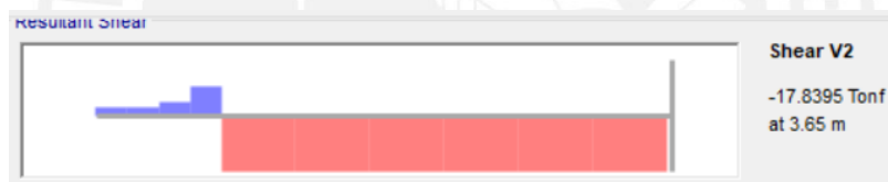
Figura 50: Diagrama de fuerzas cortantes de VC-06 (ton)
