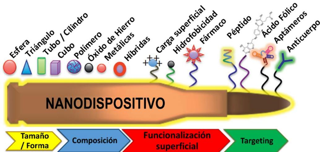
**Figura 1.3** Esquema de los factores importantes para el diseño de un nanodispositivo. Adaptado de la referencia 35 con permiso de Elsevier.©2014.
