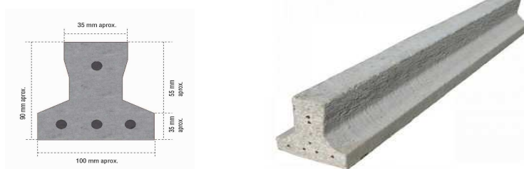
Figura 2. Geometría de la vigueta. Fuente: elaboración grafica propia
