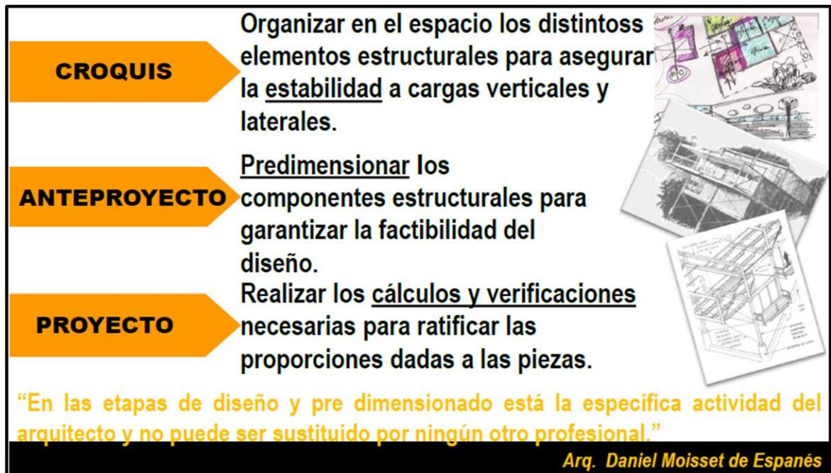
Figura 2. Proceso de diseño.
