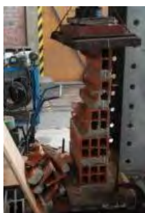
Figura 4.8. Falla de la pila PNRI-1-S (Sáenz, 2016)
