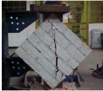
Figura 5.1. Ensayo de tracción diagonal de muretes (Lazares y Salinas, 2007)
