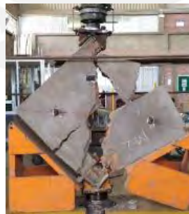
Figura 5.15. Falla del murete MUNRI-2-BE (Bazalar y Espinoza, 2020)
