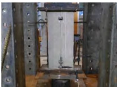
Figura 4.11. Ensayo de una pila de ladrillo pandereta industrial (Bazalar y Espinoza, 2020)
