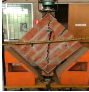
Figura 5.6. Falla del murete MUNRI-2-S (Sáenz, 2016)
