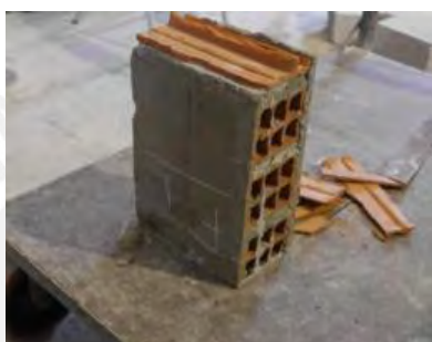
Figura 4.12. Falla de la pila PNRI-1-BE (Bazalar y Espinoza, 2020)
