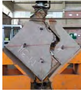
Figura 5.16. Falla del murete MUNRI-3-BE (Bazalar y Espinoza, 2020)
