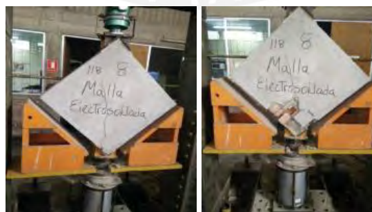
Figura 5.23. Falla de tracción diagonal del murete MURI-2-CD (Cevallos y Diaz, 2018)
