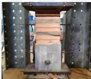
Figura 4.13. Falla de la pila PNRI-2-BE (Bazalar y Espinoza, 2020)
