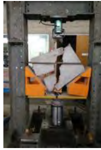
Figura 5.10. Falla por tracción diagonal del murete MUNRI-2-CD (Cevallos y Diaz, 2018)
