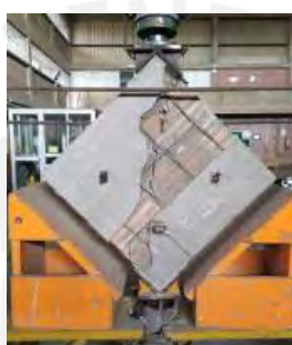
Figura 5.29. Falla del murete MURI-3-BE (Bazalar y Espinoza, 2020)
