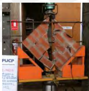
Figura 5.5. Falla del murete MUNRI-1-S (Sáenz, 2016)
