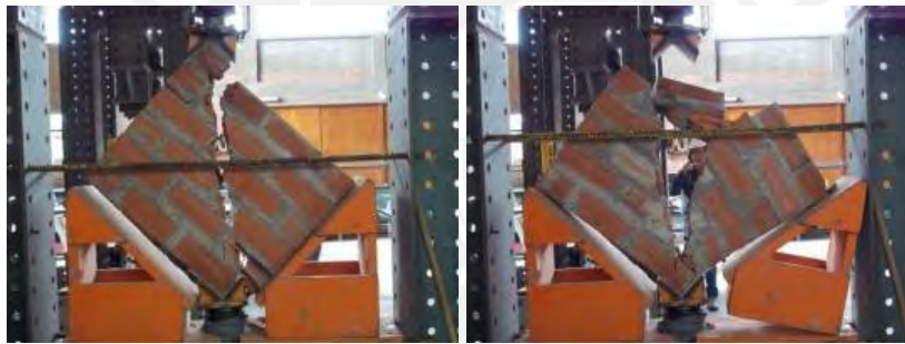
Figura 5.4. Forma de falla de los muretes MUNRI-3-AV y MUNRI-4-AV (Araoz y Velezmoro, 2012)
