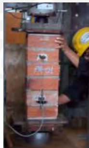
Figura 4.3. Colocación de una pila a ensayar (Araoz y Velezmoro, 2012)
