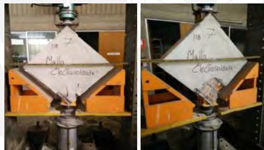
Figura 5.22. Falla local en la parte inferior del murete MURI-1-CD (Cevallos y Diaz, 2018)
