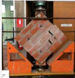
Figura 5.7. Falla del murete MUNRI-3-S (Sáenz, 2016)
