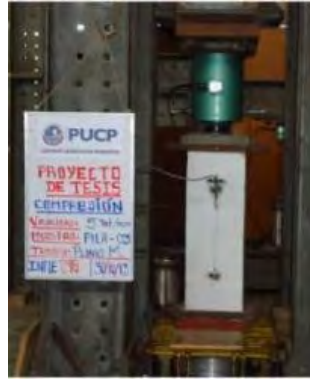
Figura 4.17. Ensayo de una pila reforzada con malla electrosoldada (Mamani, 2015)
