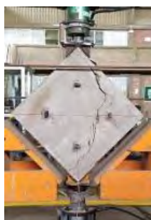
Figura 5.28. Falla del murete MURI-2-BE (Bazalar y Espinoza, 2020)
