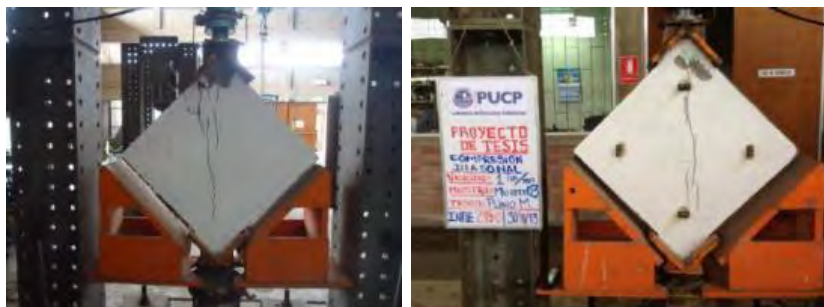
Figura 5.20. Forma de falla de los muretes MURI-2-M y MURI-3-M (Mamani, 2015)
