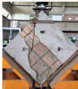
Figura 5.27. Falla del murete MURI-1-BE (Bazalar y Espinoza, 2020)
