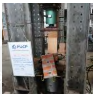
Figura 4.9. Falla de la pila PNRI-2-S (Sáenz, 2016)
