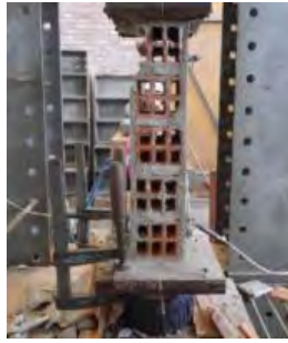
Figura 4.14. Falla de la pila PNRI-3-BE (Bazalar y Espinoza, 2020)
