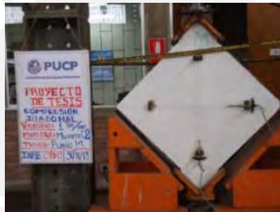
Figura 5.18. Murete reforzado instrumentado (Mamani, 2015)
