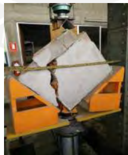
Figura 5.9. Falla mixta del murete MUNRI-1-CD (Cevallos y Diaz, 2018)
