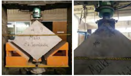
Figura 5.24. Falla local del murete MURI-3-CD (Cevallos y Diaz, 2018)
