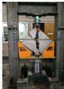
Figura 5.11. Falla por tracción diagonal del murete MUNRI-3-CD (Cevallos y Diaz, 2018)
