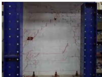
Figura 6.15. Estado final del muro MNRI-CCA-Z (Zavala et al., 2014)
