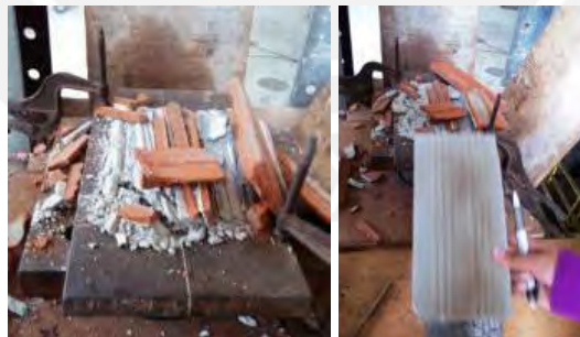
Figura 4.5. Falla del capping por trituración en la base de la pila PNRI-4-AV (Araoz y Velezmoro, 2012)
