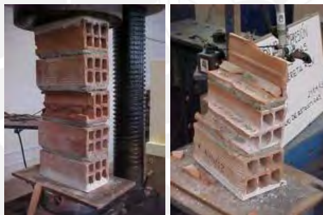
Figura 4.1. Forma de falla a compresión de pilas de albañilería. Artesanal (izquierda) e industrial (derecha) (Lazares y Salinas, 2007)
