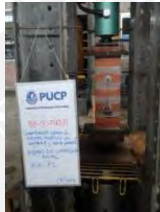
Figura 4.6. LVDT en la pila PNRI-1-S (Sáenz, 2016)
