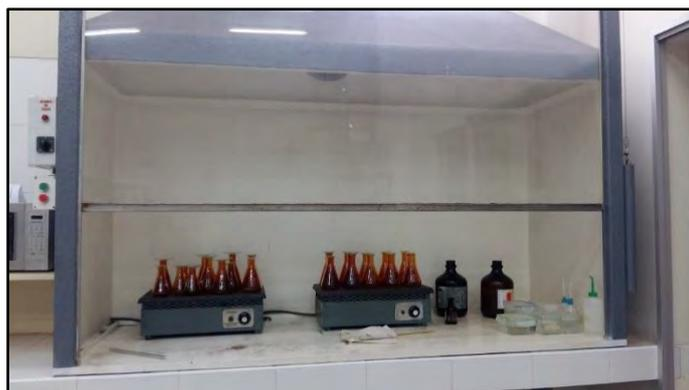
*Figura 21* Incremento de temperatura para la eliminación de materia orgánica dentro de la campana extractora de gases.
