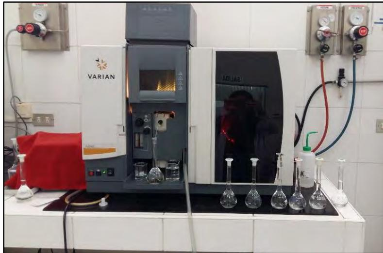
Figura 25 Equipo para Espectrometría de Absorción Atómica.
