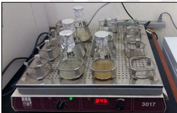
Figura 16 Agitador mecánico de laboratorio
