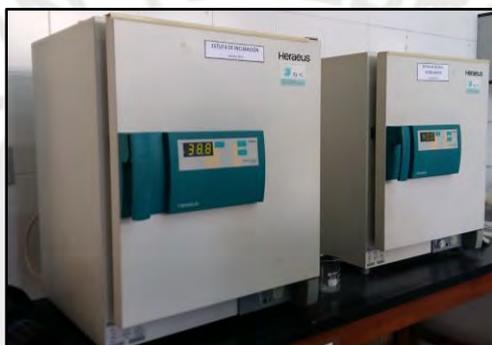
Figura 20 Horno marca Heraeus que se utilizó para el secado de las plantas.
