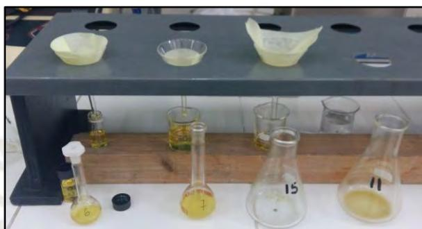
*Figura 22* Filtración de muestras antes de ser sometidas a Análisis de Absorción Atómica.
