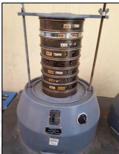
Figura 13 Equipo RO-TAP ensamblado con los tamices escogidos.
