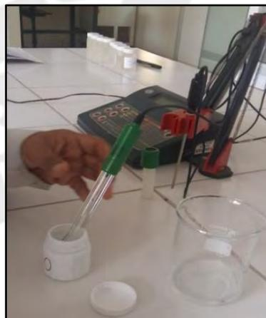
Figura 17 Medición de muestras filtradas con ph-metro.
