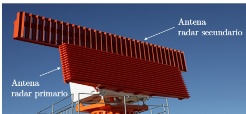
Figura 3-16. Radar Lanza. Antenas del radar primario y del secundario (fuente: www.indra.es )
