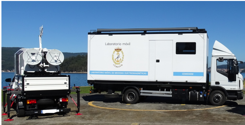
Figura 3-28. DIAR y el laboratorio móvil del Centro de Medidas Electromagnéticas (CEMEDEM) (fuente: Armada Española).
