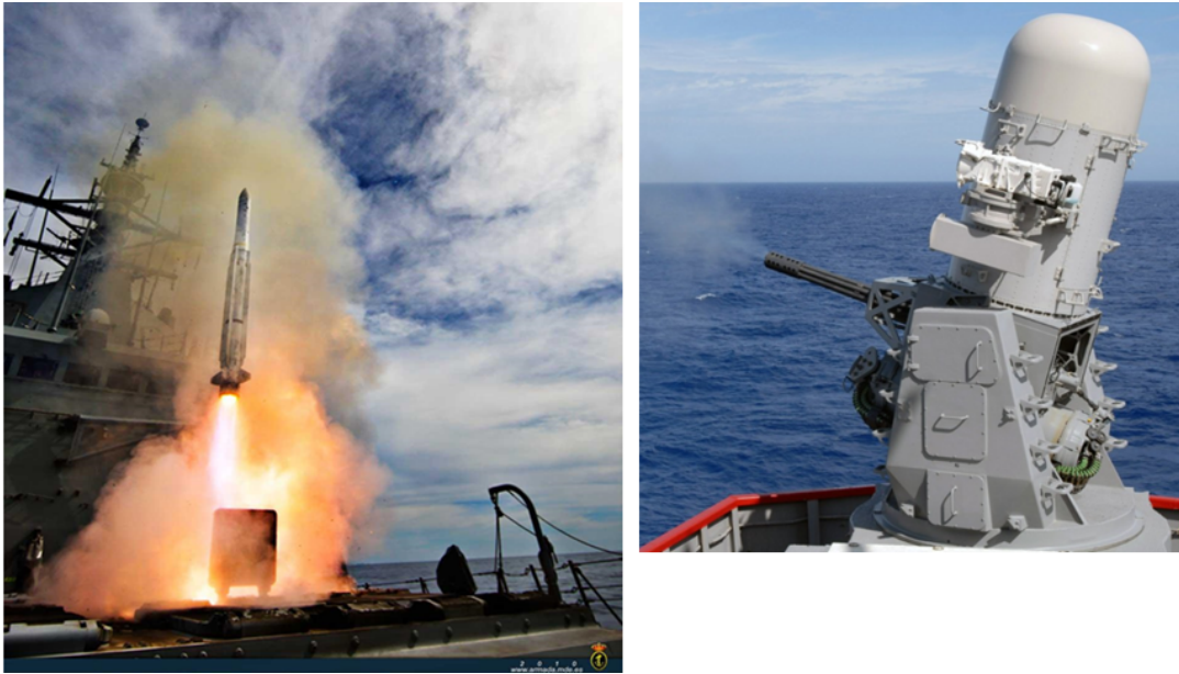
Figura 2-16. Lanzamiento de un misil ESSM (izquierda) y Cañón CIWS Vulkan Phallax de la Marina de los EEUU (Fuentes: Armada Española, www.seaforces.org )
