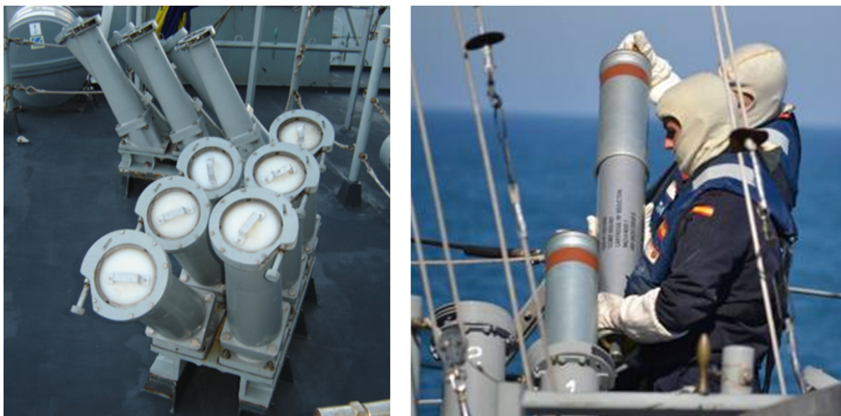
Figura 2-13. Lanzadores MK-36 (izquierda) y dos miembros de la dotación del buque cargando señuelos (derecha) (Fuente: www.foronaval.com y Armada Española)
