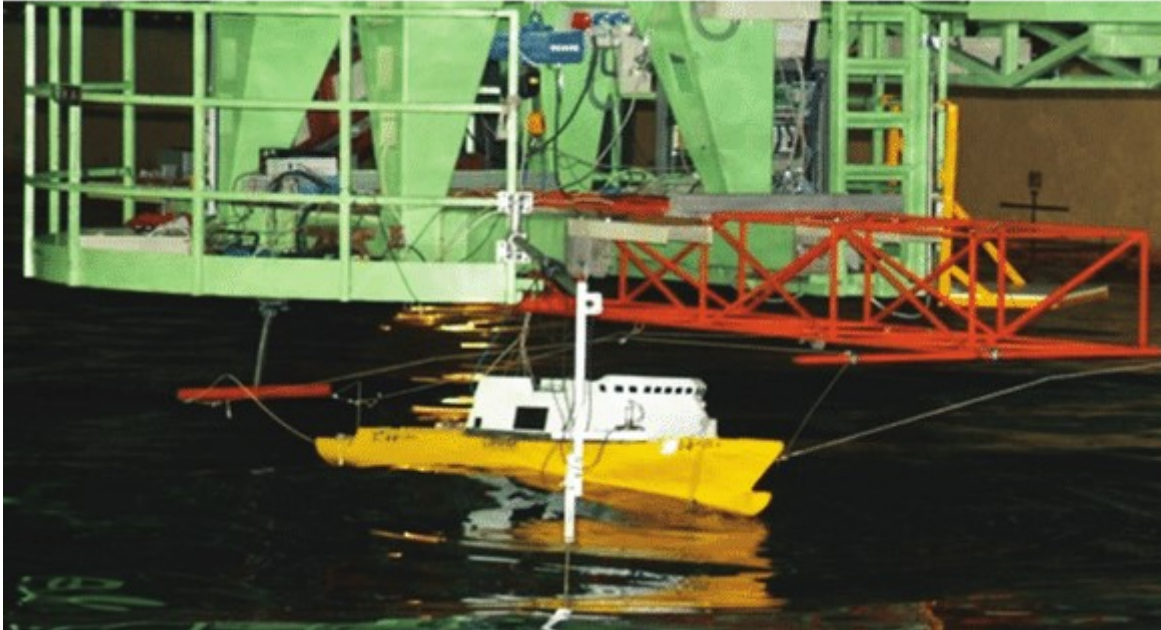
Figura 4-4. Modelo físico de un buque en el Canal de Experiencias Hidrodinámicas de El Pardo (CEHIPAR) (Fuente: CEHIPAR)
