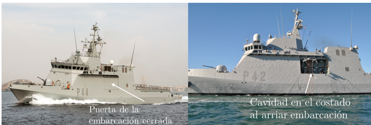
Figura 3-25. Puerta de la maniobra de arriado de botes en un patrullero tipo BAM de la Armada. (Fuente: Armada Española)
