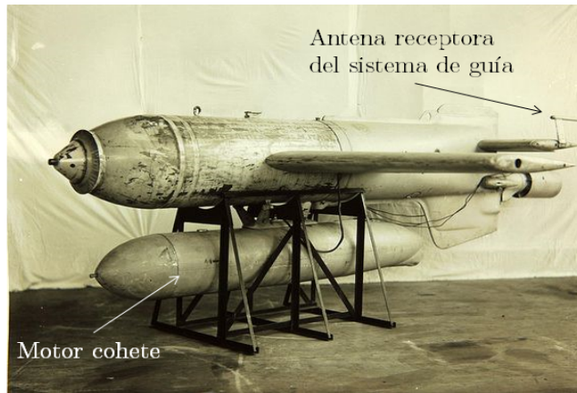
Figura 1-2. Misil Henschel Hs 293. (Fuente: San Diego Air & Space Museum Archivos en flickr)
