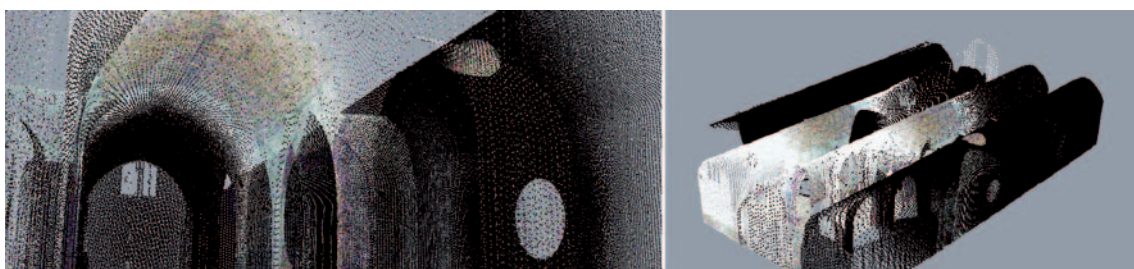
Figura 12. Detalle del interior y vista de las nubes de puntos unidas, capturadas mediante un láser escáner
