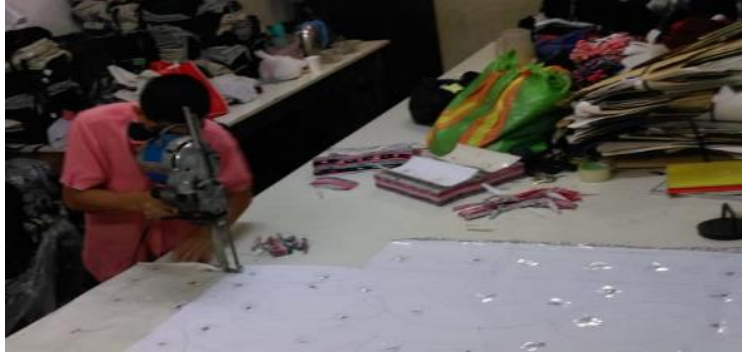
Figura 12. Personal trabajando sin EPP
