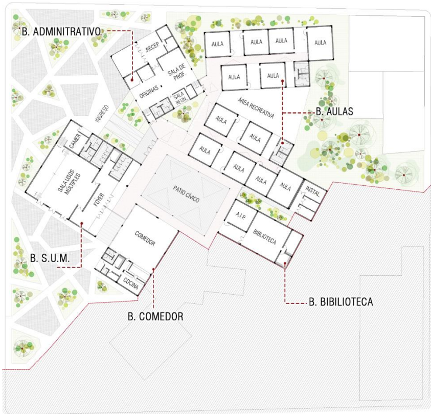
Ilustración 34: Planta del Proyecto - Cota 2m. Fuente: Propia
