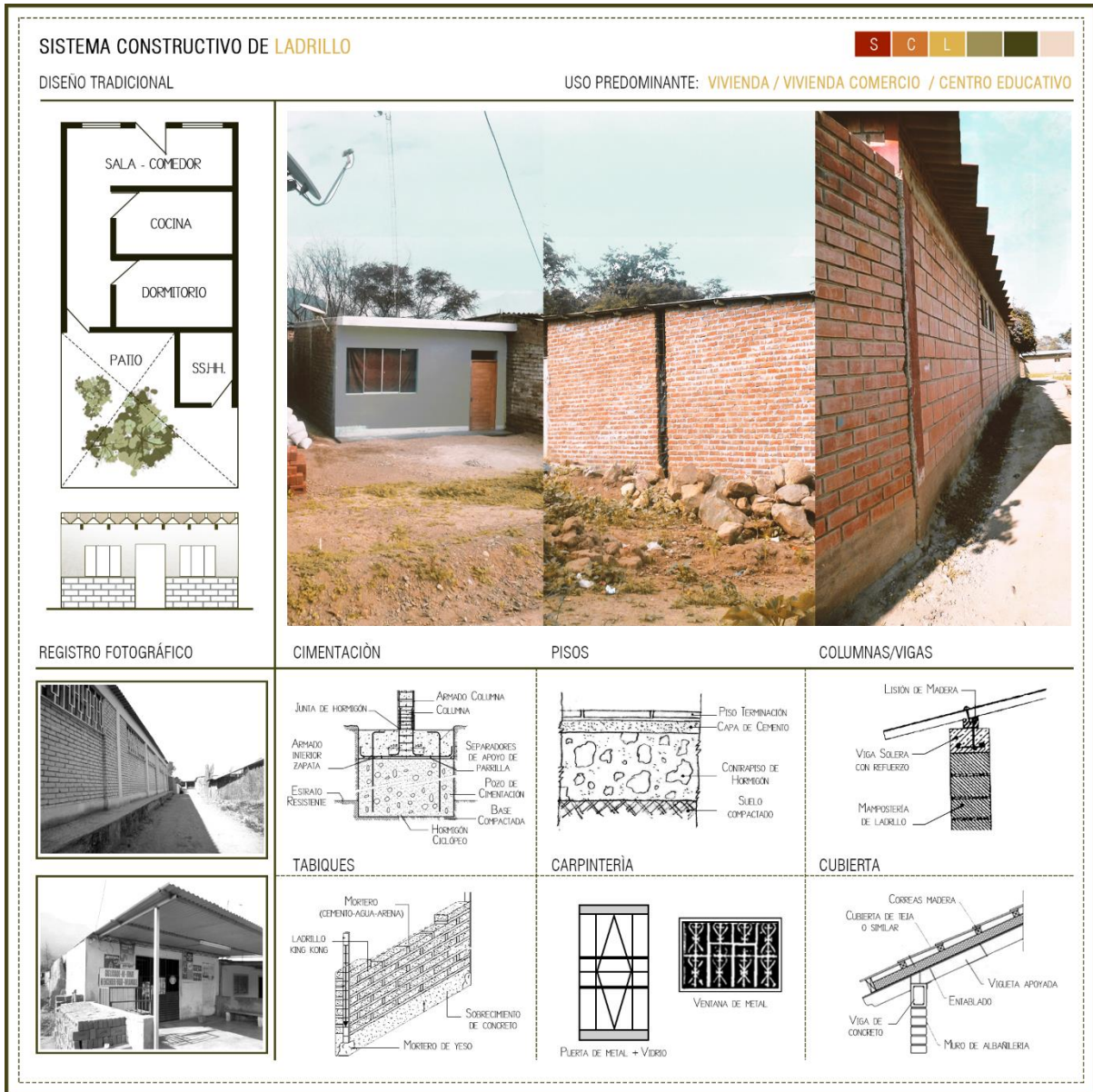
Ilustración 19: Sistema Constructivo de Ladrillo, Materialidad y técnicas constructivas del centro poblado. Fuente: Propia
