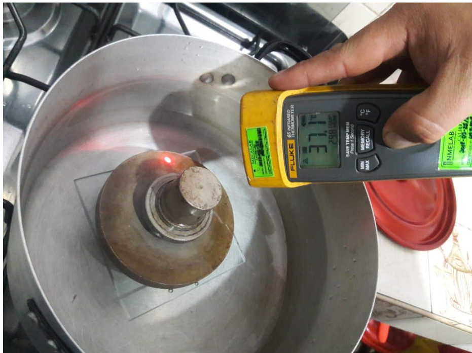
Fig 05. Muestra sumergida durante 3 minutos en agua a temperatura ambiente para simular la temperatura promedio de la cavidad oral
