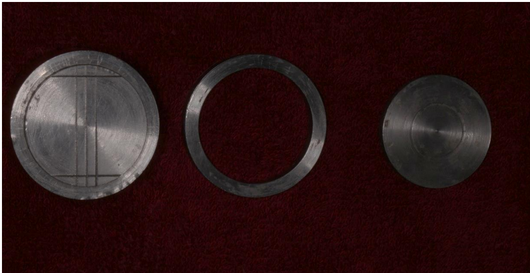
Fig 02. Partes del dispositivo metálico: cuerpo, anillo y disco de arrastre respectivamente
