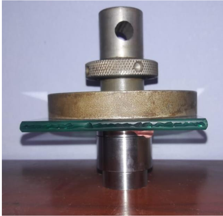
Fig 04. Colocación de platina y peso de 5 kg encima del dispositivo metálico, simulando la fuerza de mordida al tomar el registro
