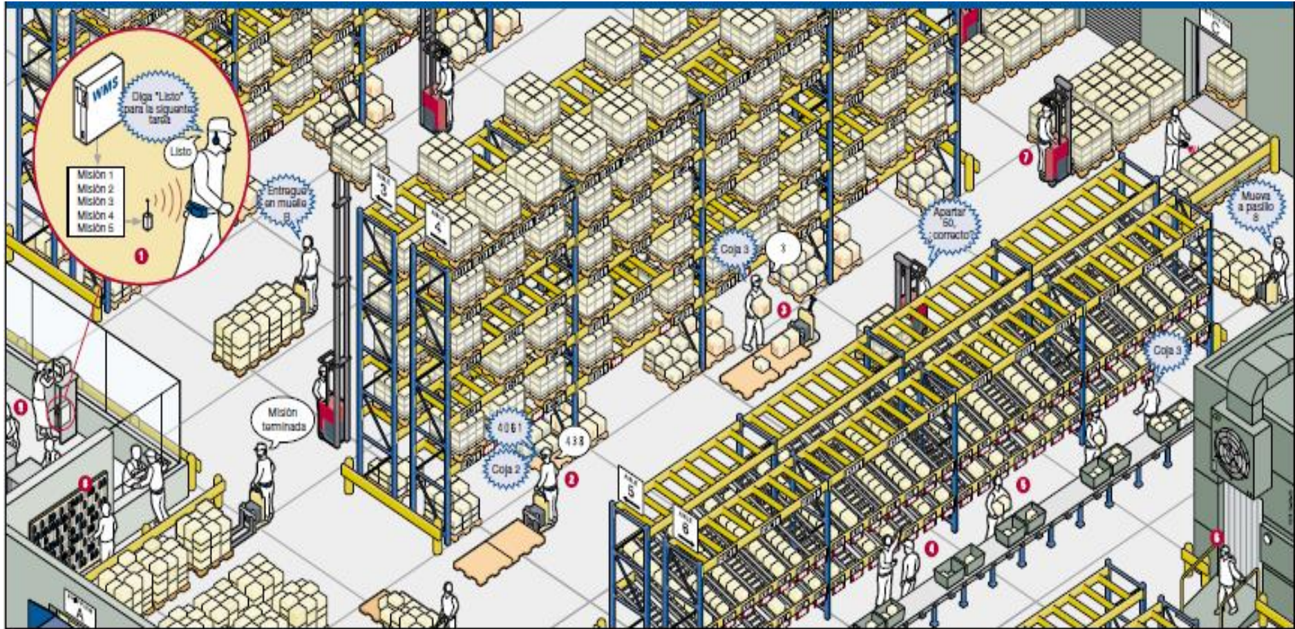
Figura N° 10: Funcionamiento del picking to voice
