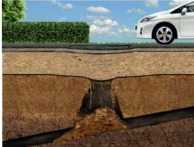
Figura 60. Geotextil Tejido de alta resistencia y baja fluencia
