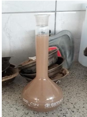
FIGURA N° 11. MUESTRA DEPOSITADA EN FIOLA CON AGUA DESTILADA
