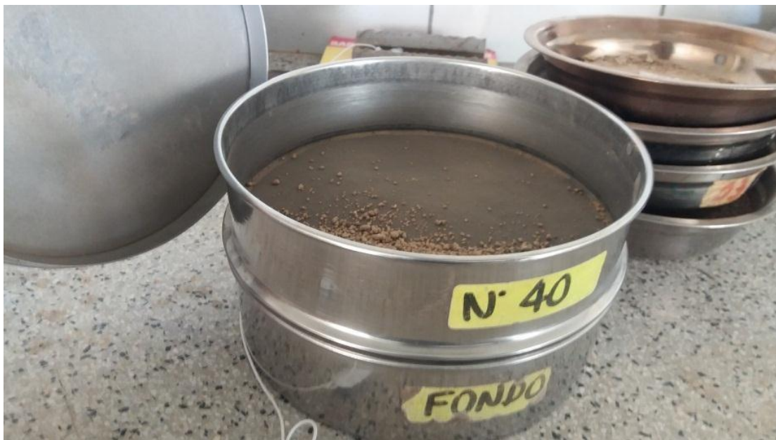
FIGURA N° 13. MUESTRA TAMIZADA PARA EL ENSAYO DE LÍMITES DE ATTEMBERG
