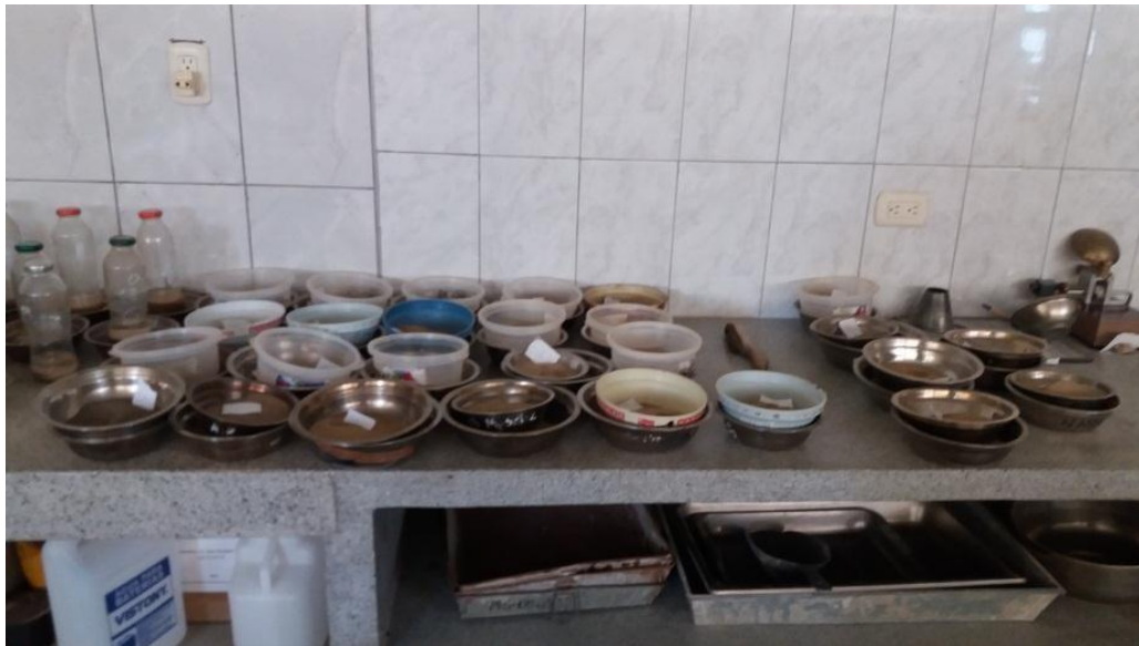
FIGURA N° 14. MUESTRAS DE LAS DIFERENTES CALICATAS Y ESTRATOS PARA SU RESPECTIVO ANÁLISIS
