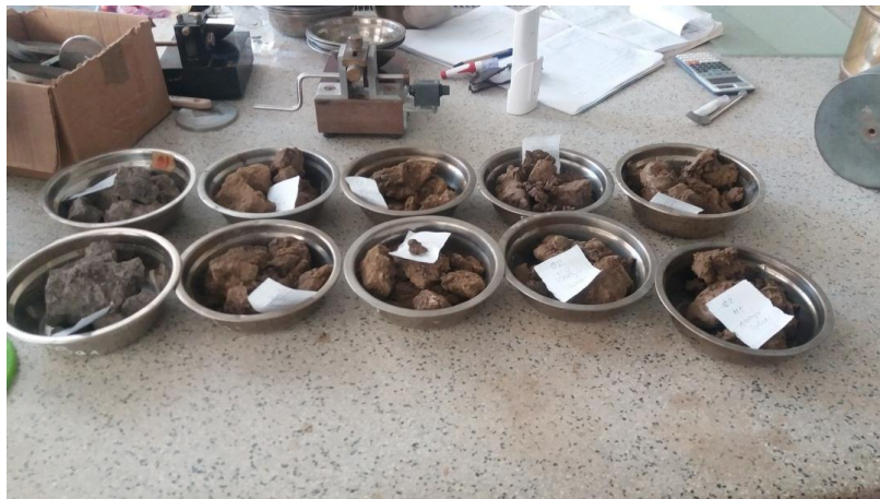
FIGURA N° 9. MUESTRA ALTERADAS PARA ENSAYO DE CONTENIDO DE HUMEDAD
