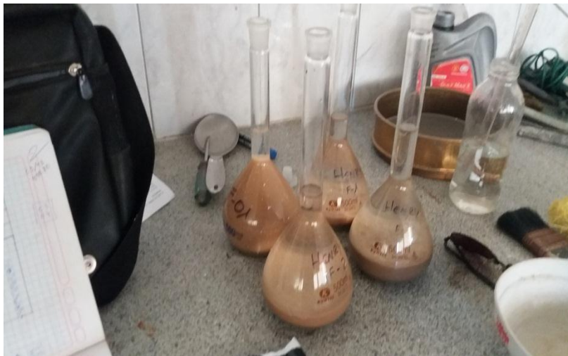
FIGURA N° 12. MUESTRA DECANTADA EN FIOLA CON AGUA DESTILADA
