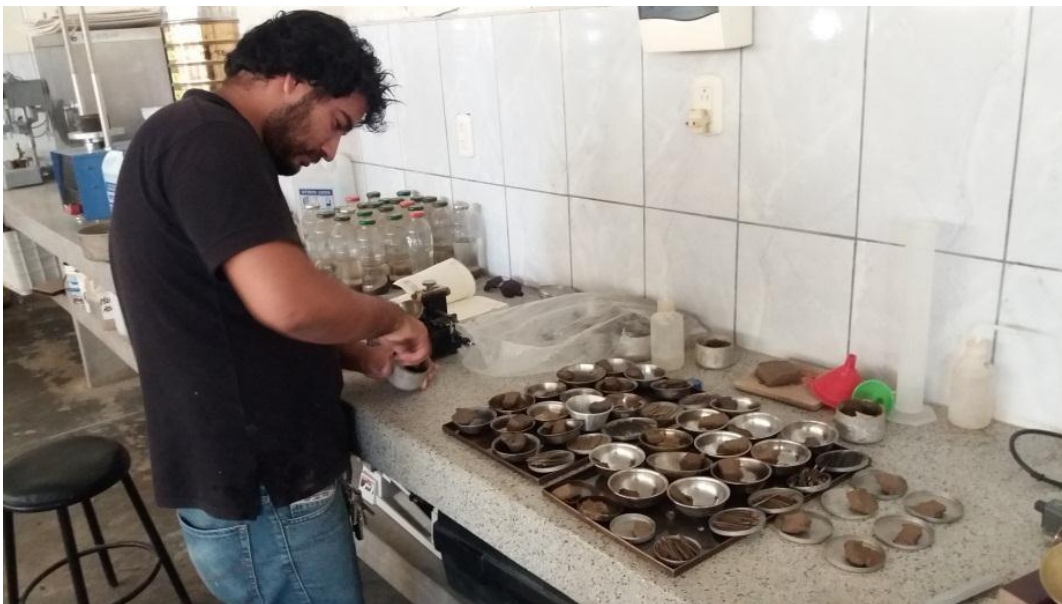
FIGURA N° 17. ENSAYO DE LÍMITE LÍQUIDO
