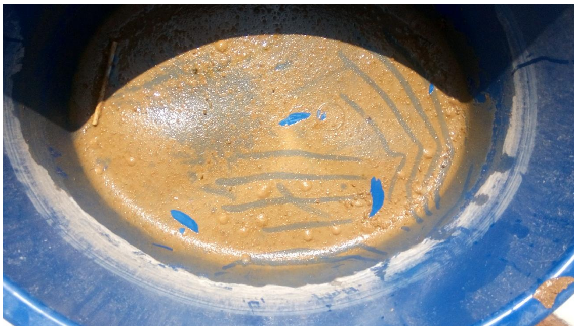
FOTOGRAFÍA 1.27: RESIDUOS DE FINOS PERDIDOS
