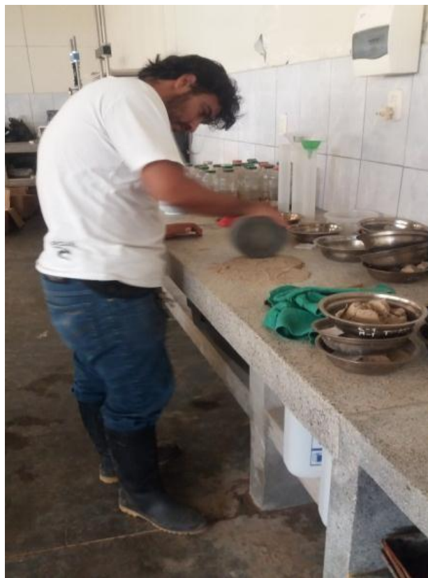
FIGURA N° 15. MUESTRA TRITURADA PARA SU RESPECTIVO TAMIZADO
