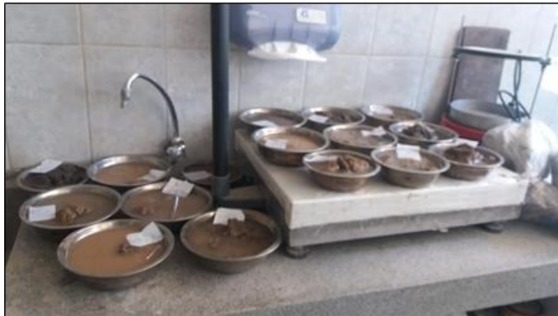
FIGURA N° 5. SATURACIÓN PARA EL ANÁLISIS GRANULOMÉTRICO DE SUELO
