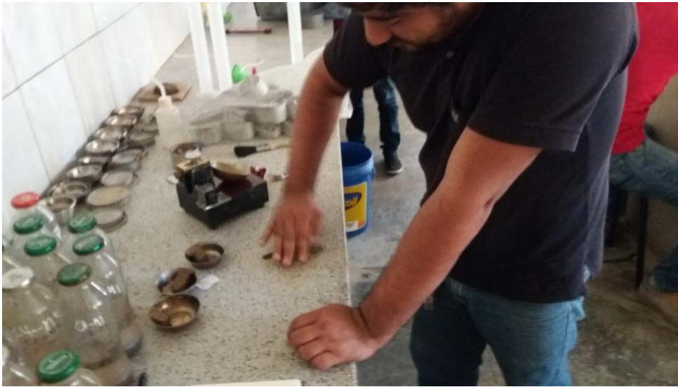
FIGURA N° 16. ENSAYO DE LÍMITE PLÁSTICO
