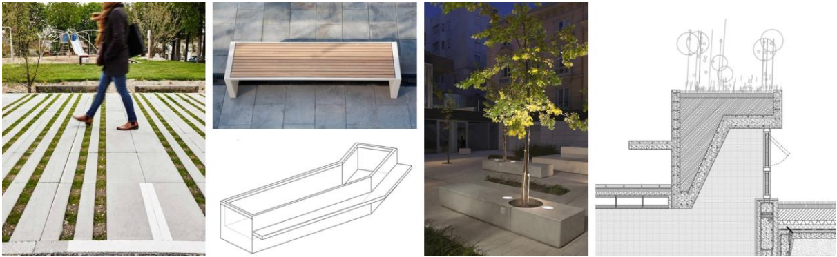
Imagen 91. Pavimentación y mobiliario urbano. De izquierda a derecha: Pavimento flexible: concreto + grass natural (Imagen extraída de Urban Landscape https://www.pinterest.es/pin/547257792202247766/ ), banca de concreto (Imagen extraída de Escofet.SA), isométrico de banca (diseño propio), banca de concreto con diseño incorporando un árbol (Escofet.SA) y Sección Constructiva de una de las bancas de la propuesta (diseño propio).
