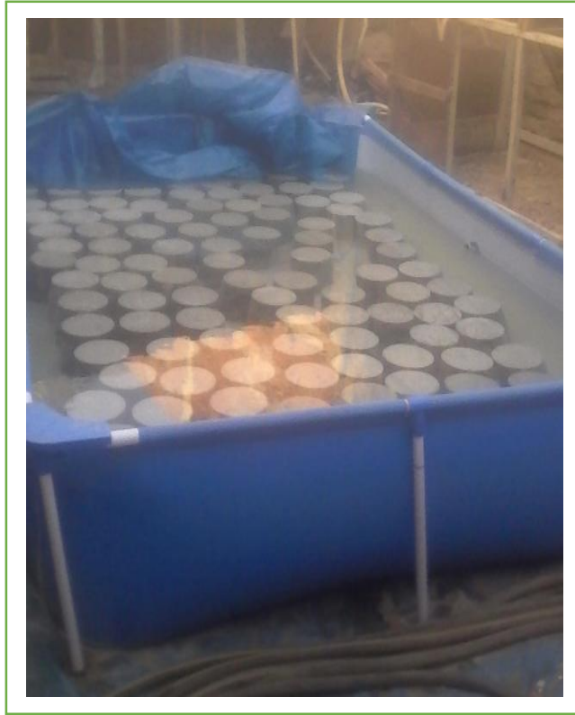
Anexo N.º 16.3: Curado de muestras cilíndricas en laboratorio, piscina de 4.00 m x 2.20 m
