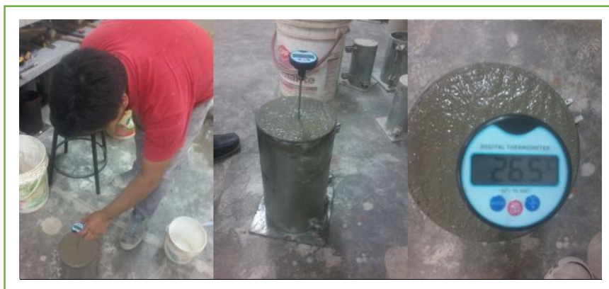
Figura N° 17. Determinación de la temperatura del concreto fresco
