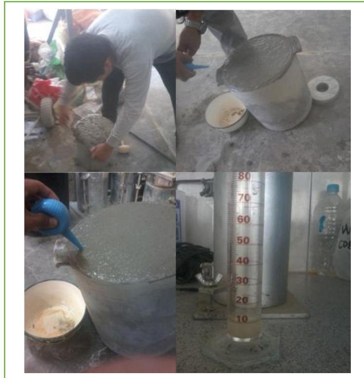
Figura N° 16. Exudación del concreto fresco
