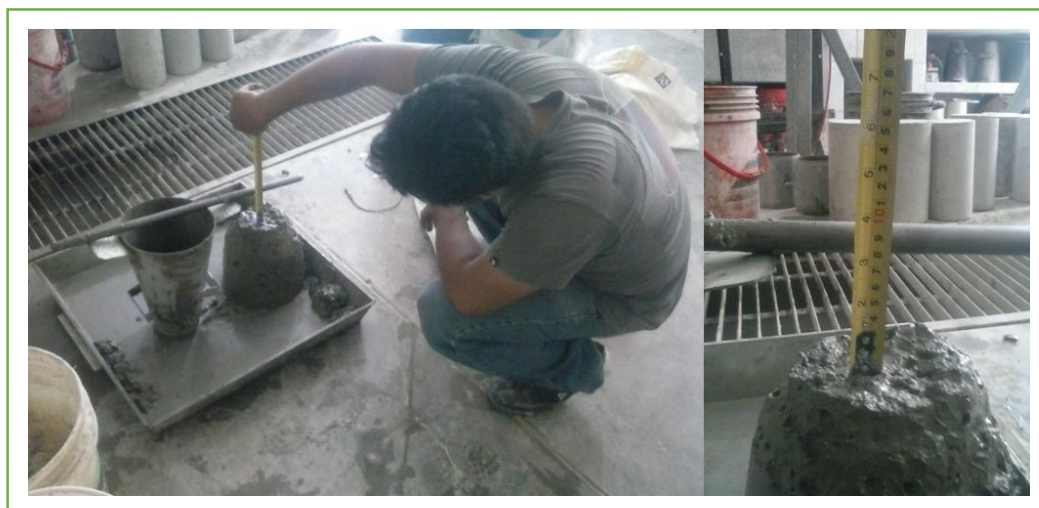
Figura N° 15. Asentamiento del concreto con cono de Abrams
