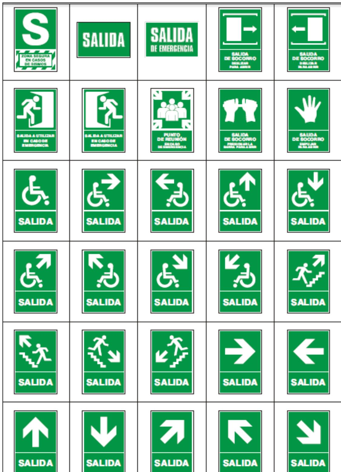
Figura N°50: Señalización de evacuación y emergencia
