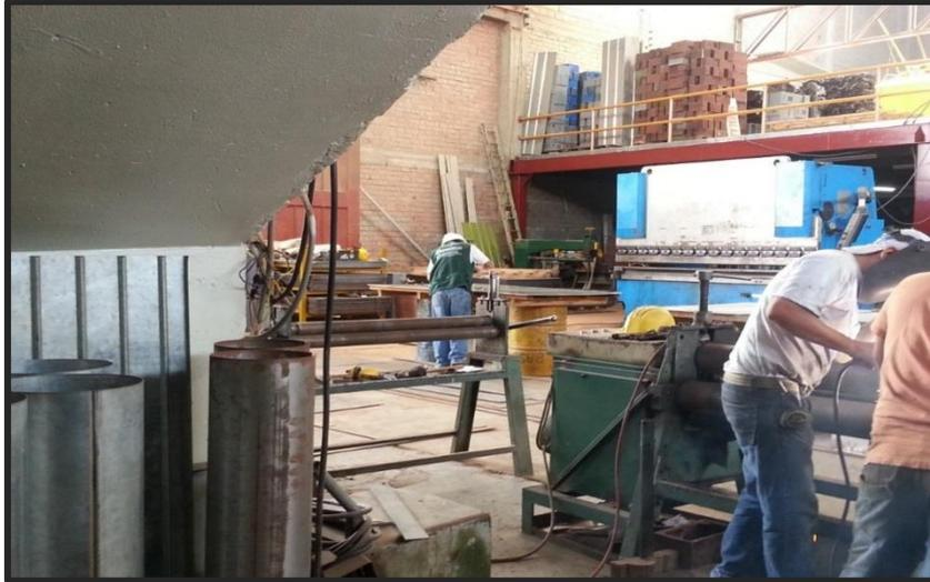
**Nota:** Se puede evidenciar que el material de sistemas eléctricos se encuentran expuestos; así como las máquinas de soldadura las cuales tienen más de 8 años de antigüedad.
