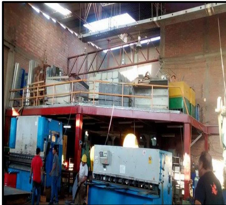
**Nota:** El operario se encuentra propenso a sufrir algún accidente debido a que el material es almacenado en una segunda planta. Además, de no contar con la protección de los equipos necesarios.
