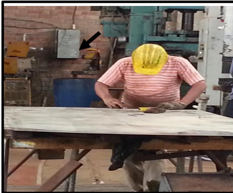
**Nota:** Los sistemas eléctricos no registran ningún tipo de aviso de peligro o señalización, que indique la presencia de altos voltajes.
