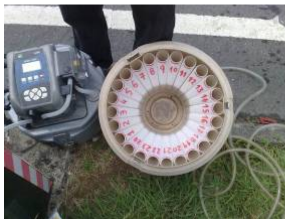
Figura 7.- Detalle del tomamuestras automático con la unidad de control y la bomba peristáltica de toma de muestras y disposición de las 24 botellas para la toma de muestras.
