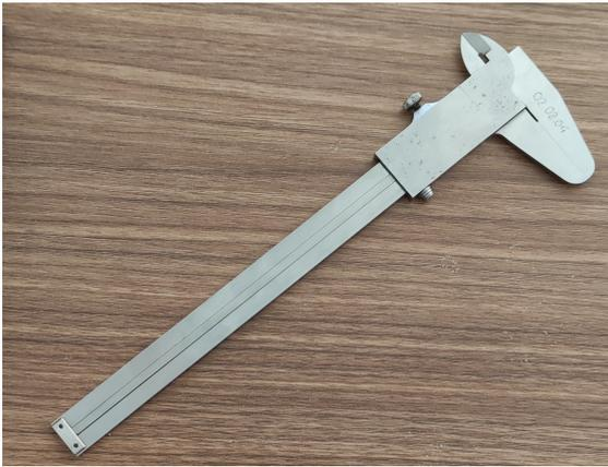
(a) Pie de rey utilizado en el ensayo.
