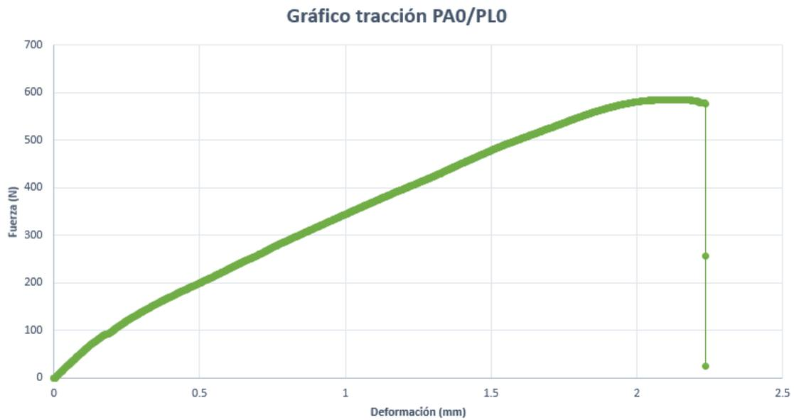
Figura 4.17: Gráfica de tracción del material PLA por degradación mediante luz solar en la semana 1.
