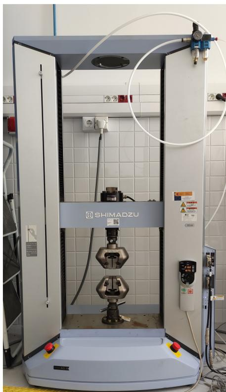
Figura 3.17: Equipo empleado para los ensayos de tracción.
