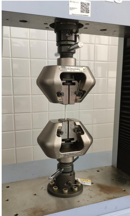
Figura 3.19: Probeta colocada en las mordazas antes del ensayo.
