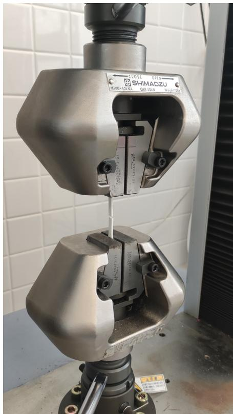
Figura 3.20: Probeta colocada en las mordazas después del ensayo.
