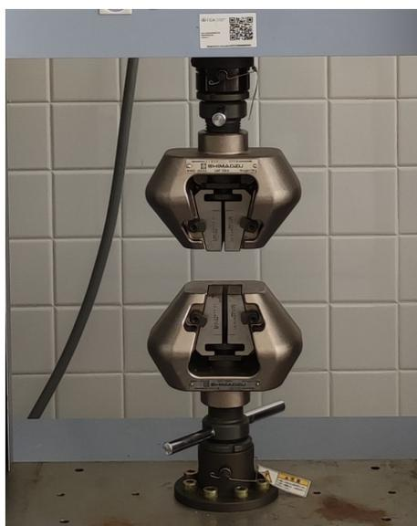
Figura 3.18: Mordazas empleadas para los ensayos de tracción.
