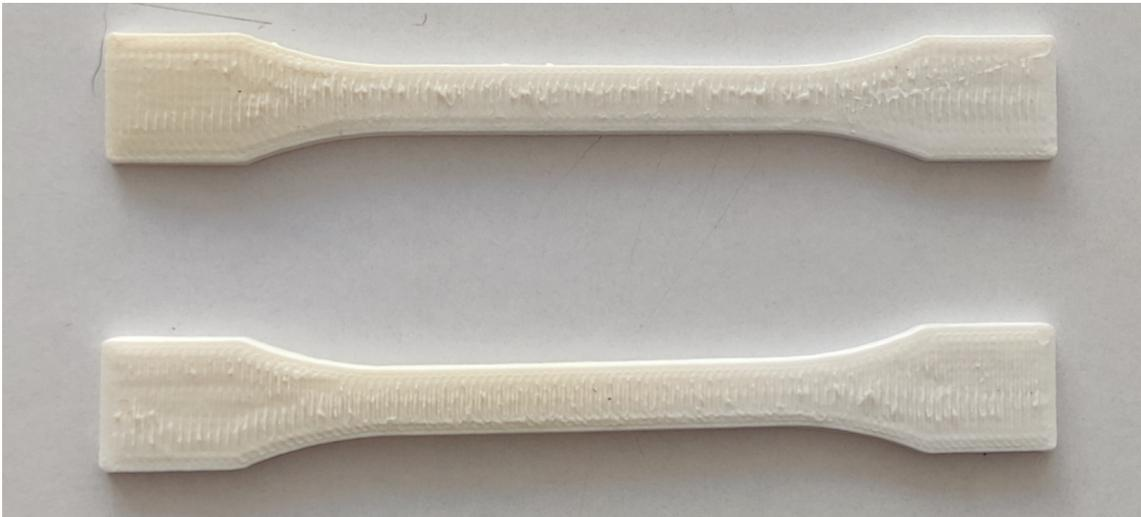
Figura 4.7: Representación de las probetas quemadas después de la semana 8.
