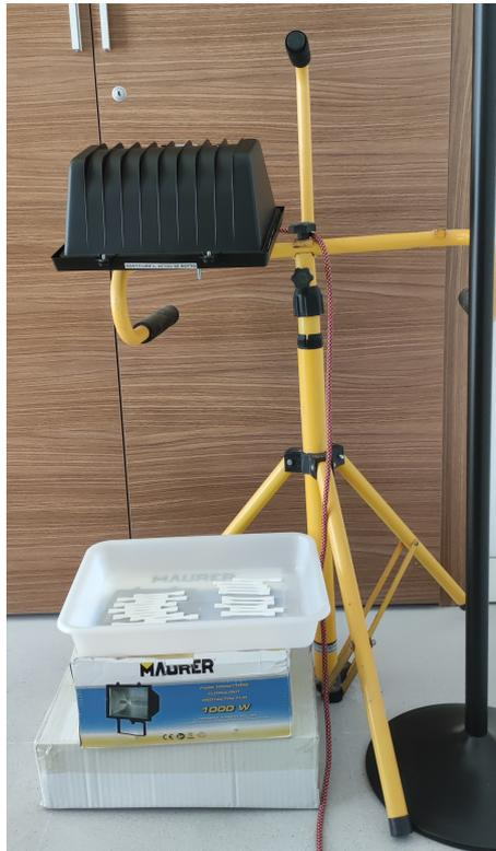
Figura 3.14: Lámpara foto alógena utilizada para la simulación de luz solar.
