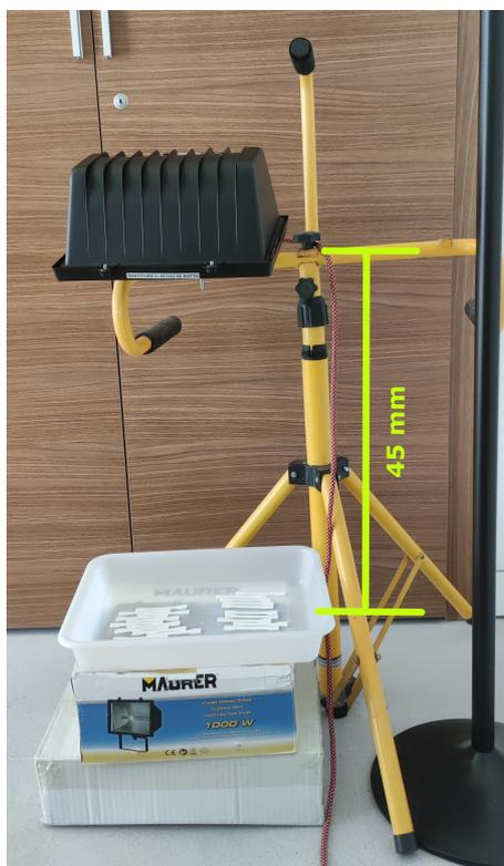
Figura 3.16: Distancia entre la lámpara y las probetas para conseguir 1000J de energía.
