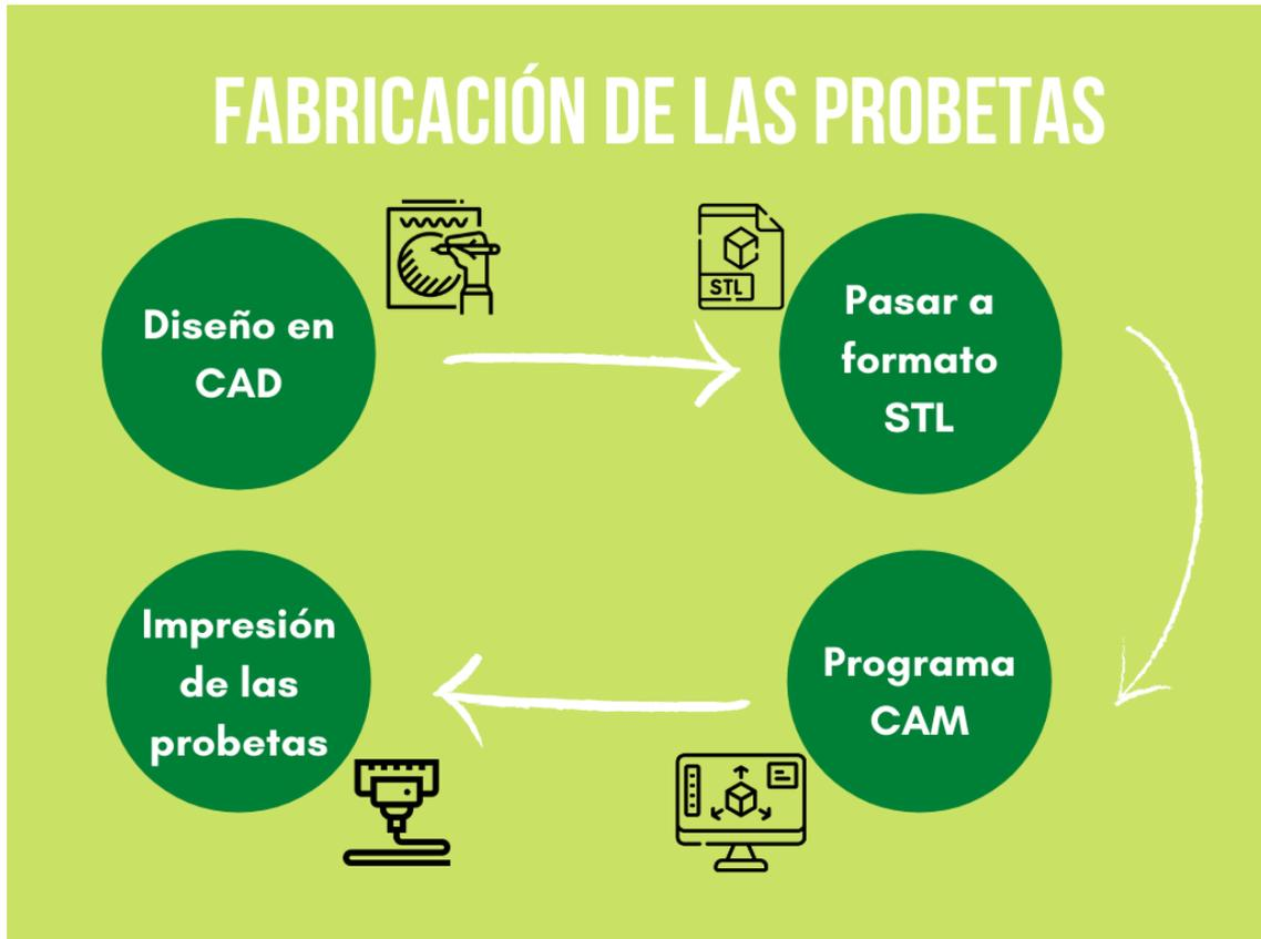
Figura 3.3: Diagrama representativo del proceso de fabricación.
