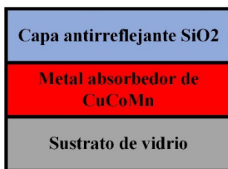
Figura 4.12. Esquema de un recubrimiento multicapa depositado sobre un sustrato de vidrio.
