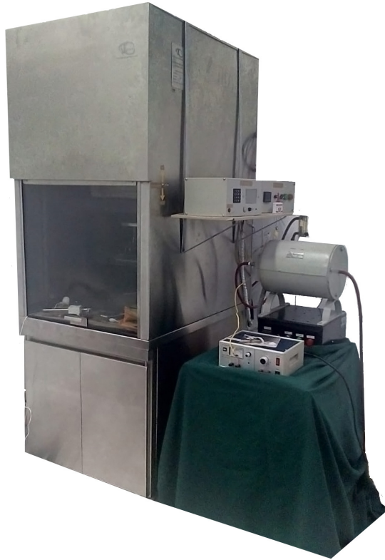
Figura 2.17. Distribución externa de los equipos que controlan los diferentes parámetros de depósito. El equipo AACVD implementado se encuentra dentro de la campana extractora.
