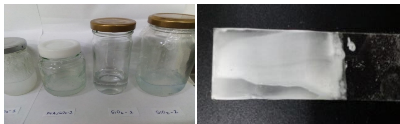
Figura 4.14. Fotografías de soluciones de \text{SiO}_2 : (a) Soluciones \text{SiO}_2 en diferentes relaciones molares y (b) Película delgada de PVA- \text{SiO}_2 .
