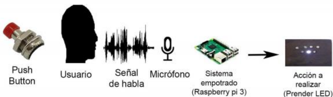
Figura 32 Proceso de funcionamiento del sistema [39].
