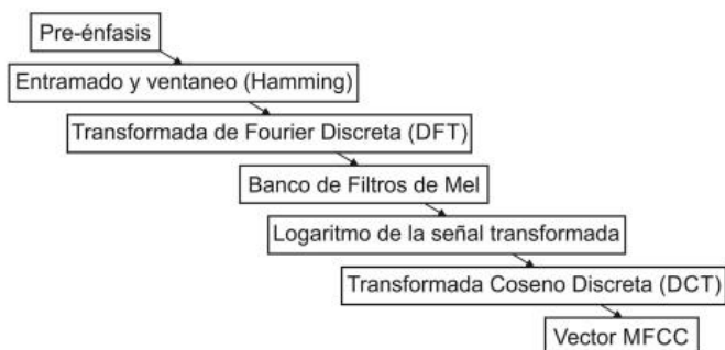
Figura 4 Proceso de obtención de los coeficientes MFCC.
