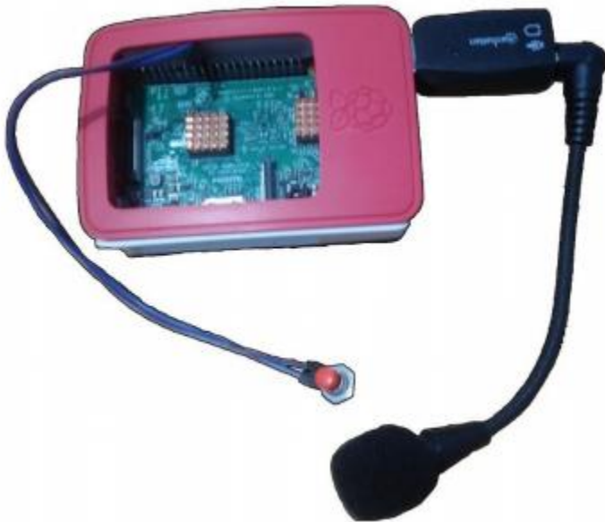
Figura 31 Sistema para obtener la señal de audio [39]
