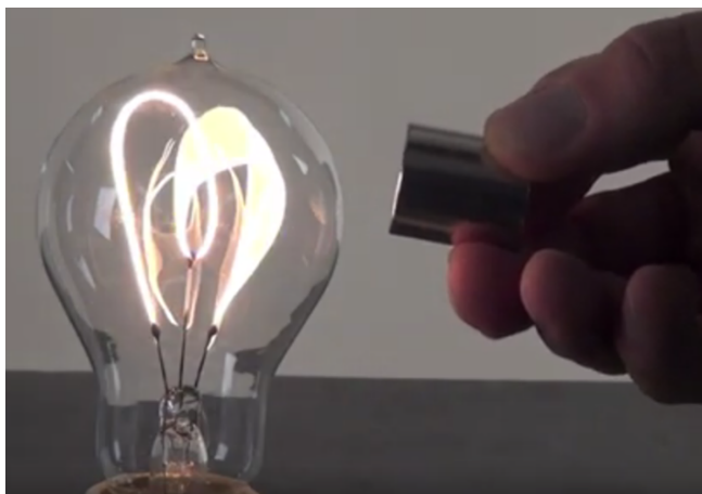
Fig. 1. El filamento de carbono de la bombilla vibra cuando circula corriente AC y se le aproxima un imán.
