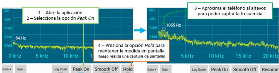
**Figura 4.** Pasos para la utilización de la aplicación “Spectral Audio”. Fuente: Elaboración propia.
