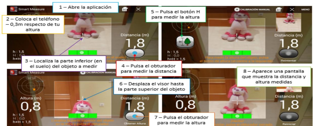
Figura 3. Pasos sobre cómo utilizar la aplicación *Smart Measure*.
