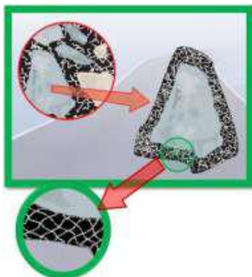
Figura 4.30 – Película de betume em redor dos agregados (Martinho et al, 2013)
