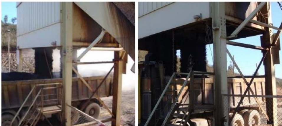
Figura 2.2 – Diferença nas emissões de fumos entre as MBQ (esquerda) e as MBT (direita) observados na central durante a descarga das misturas betuminosas para o camião (Silva et al., 2009)
