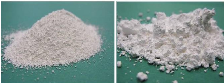
Figura 2.11 – Zeólitos Aspha-min ® (esquerda) e Advera ® (direita) (Antunes, 2014)
