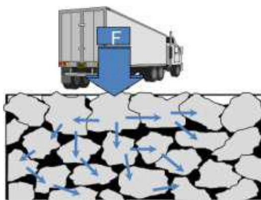
Figura 4.29 – Distribuição da carga pelo esqueleto (Martinho et al, 2013)
