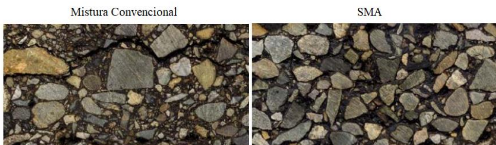
Figura 2.16 – Comparação entre o aspeto interno das misturas convencionais com as misturas SMA (El-Hage, 2012)
