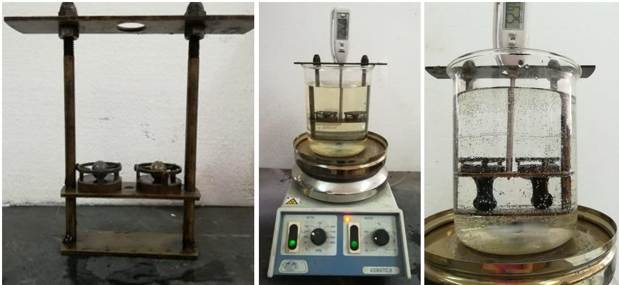
Figura 3.2 – Aspeto dos ensaios de medição da temperatura de amolecimento do betume pelo método do anel e bola
