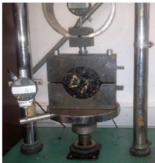
Figura 3.10 – Ensaio de compressão de Marshall (Antunes, 2014)
