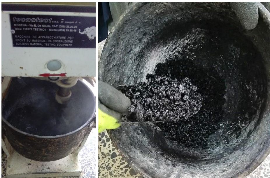
Figura 3.3 – Fabrico dos provetes
