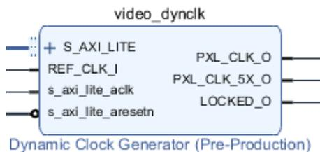
Figura 4.9: Gerador dinâmico de relógio [69].
