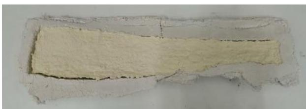
**Figura 15** – Vista geral do resultado final do preenchimento do contra-molde. É possível observar a retracção na metade esquerda do molde.
