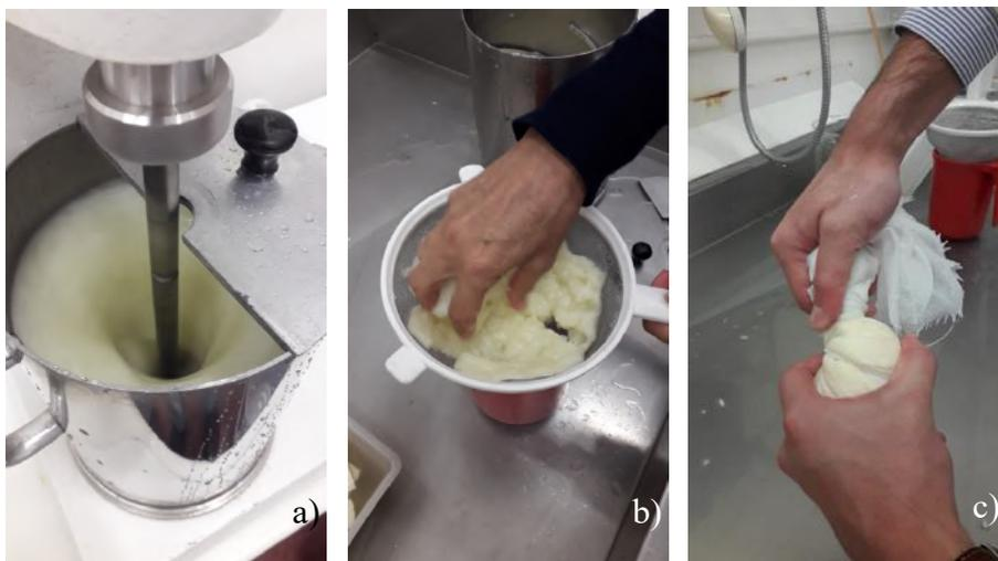
**Figura 14** - Fabricação da polpa de papel; **a)** Polpa na batedeira; **b)** Escorrimento da polpa; **c)** Escorrimento do excesso de água da polpa com ajuda do tecido nylon.
