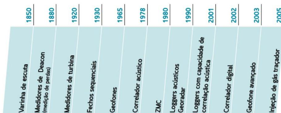
Figura 2. 4 - Evolução cronológica das técnicas de deteção de fugas (Fonte: [15])
