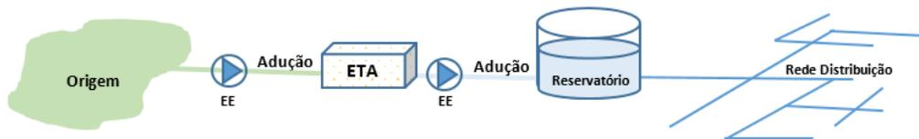
Figura 2. 1 - Representação ilustrativa dos processos típicos dos SAA
