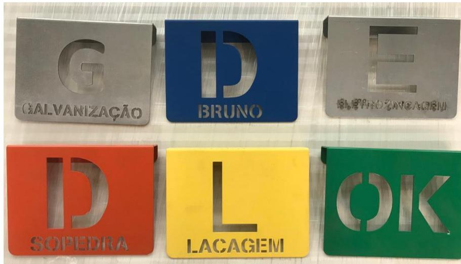
Figura 54 Cartões utilizados para separação de material CT Laser Tubo
