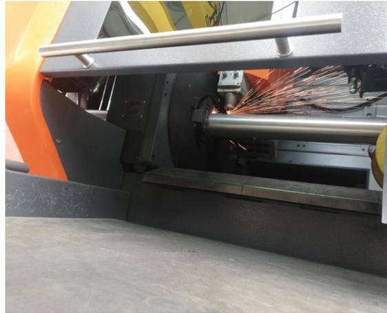
*Figura 18 Máquina de corte laser tubo*
