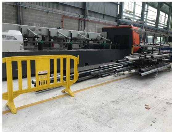
Figura 30 Máquina Corte Laser Tubo (2)
