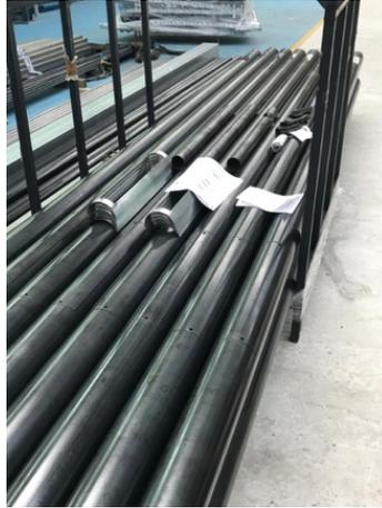
*Figura 31 Separação de material proveniente do corte de tubo*
