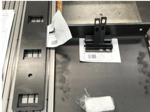
*Figura 32 Separação de material proveniente do CT laser chapa*
