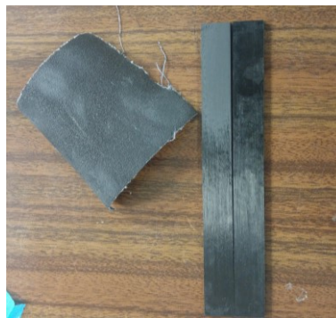
Figura 57 - Antes e depois da limpeza com o auxílio de uma lixa
