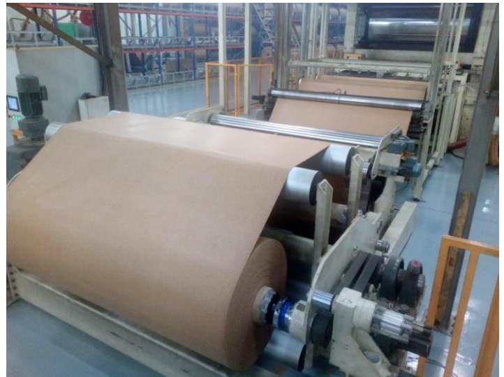
Figura 16 - Sistema de corte (lado esquerdo) e sistema de rebobinagem (lado direito) - Formação do rolo industrial
