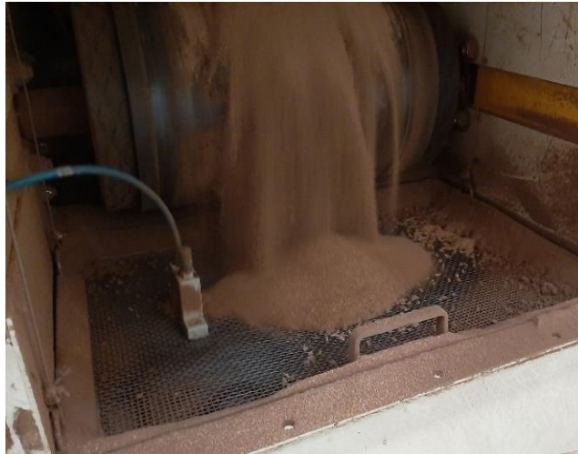
Figura 29 - Rede peneira instalada antes da misturação
