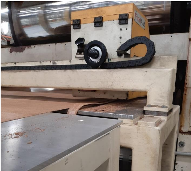
Figura 16 - Sistema de corte (lado esquerdo) e sistema de rebobinagem (lado direito) - Formação do rolo industrial
