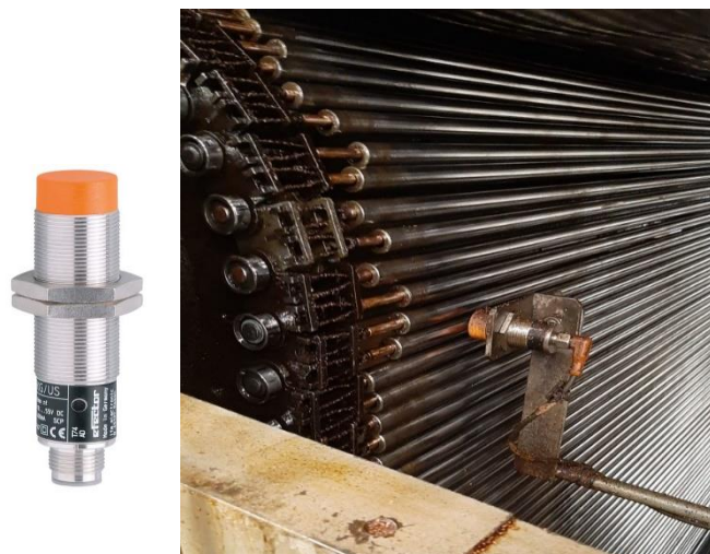
Figura 46 - Sensor indutivo utilizado no sistema de prensagem da Prensa
