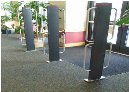
Σχήμα 5.3: Σταθεροί RFID αναγνώστες
