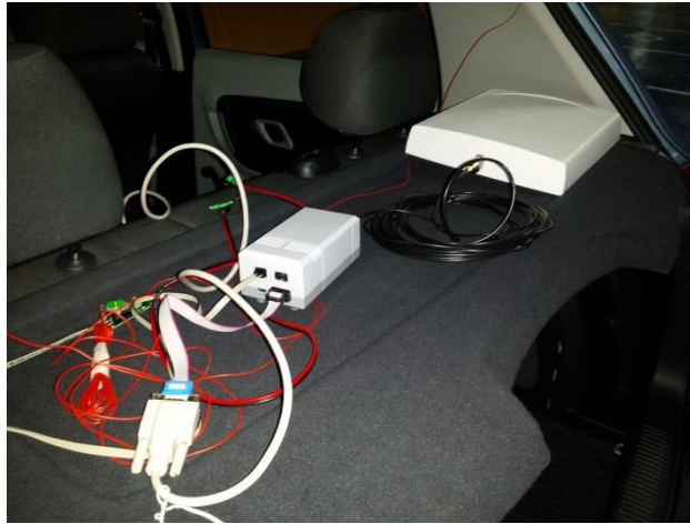
Σχήμα Π-Ι.2: RFID Αναγνώστης και RFID κεραία σε όχημα Figure Π-Ι.2: RFID Reader and RFID Antenna in a vehicle
