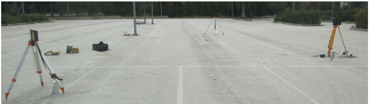
Σχήμα 7.2: Διάταξη εξοπλισμού κατά τον πειραματικό έλεγχο του συστήματος RFID σε κινηματικό εντοπισμό Figure 7.2: The Sensor setup for the testing of RFID system in kinematic mode
