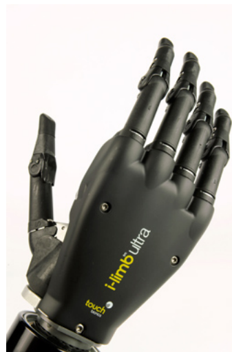
Σχήμα 1.7: Προσθετικό χέρι iLimb Ultra της TouchBionics. Πηγή: [21].
