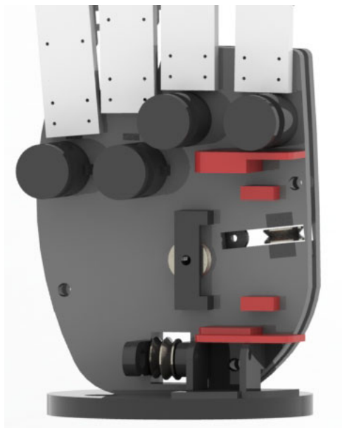
Σχήμα 2.16: Άνω μέρος παλάμης όπου με κόκκινο τονίζεται η βάση του ηλεκτρικού επενεργητή.
