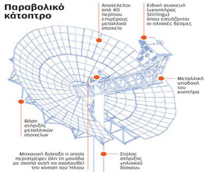
Εικόνα Α.12: Τυπική μορφή ηλιακού δίσκου
