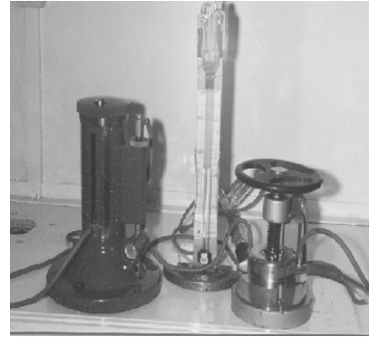
Рис. 5. Схема і загальний вигляд стенда для визначення перепаду тиску на фільтрувальному матеріалі: 1 – стабілізатор тиску; 2 – вентиль; 3 – діафрагма; 4 – манометр; 5 – затиск; 6 – компенсаційний мікроманометр
