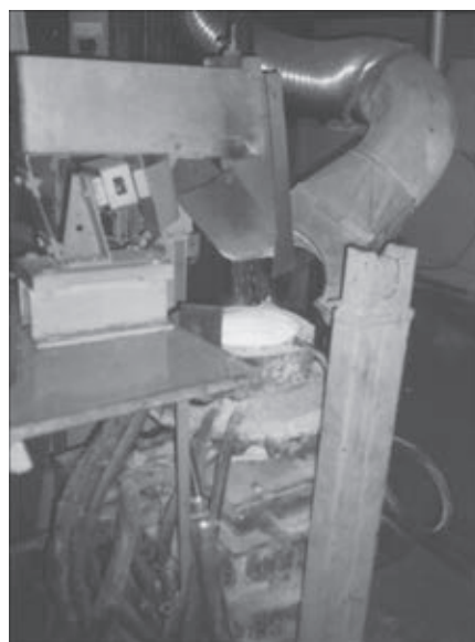
Рис. 8. Торцевая наплавка высокохромистого чугуна с подачей таблеток с помощью вибродозатора
