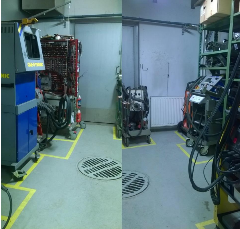
Kuva 5. Raskaiden laitteiden paikat merkittiin varastoon.
