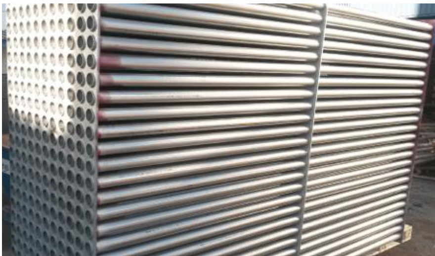
Kuva 2. Putkiluvo-paketti valmiina asennettavaksi voimakattilan takavetoon. (lähde Etelä-Savon Energia)
