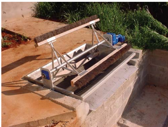
Fig. 1. Modelo de peneira rotativa utilizada no tratamento de dejetos.
