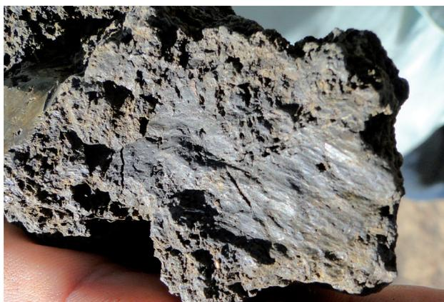
**Figura 4.26** - Detalhe de uma superfície de compressão e fricção (*slickensides*). Fotografia: Maurício Coelho, 2011.
