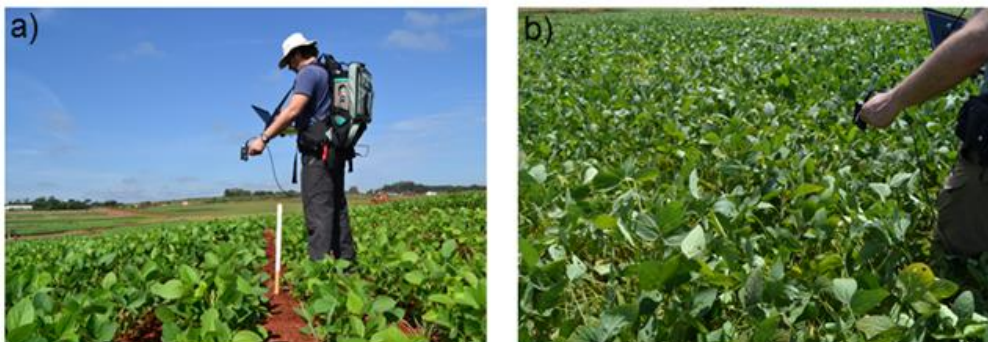
Figura 2. Medição dos espectros da soja utilizando o FieldSpec 4 High-Resolution. a) Medida feita em 29/12/2012, com a soja em estágio V5; e b) medida feita em 29/01/2013, com a soja em estágio R5.3. Foto: Arquivo Embrapa.
