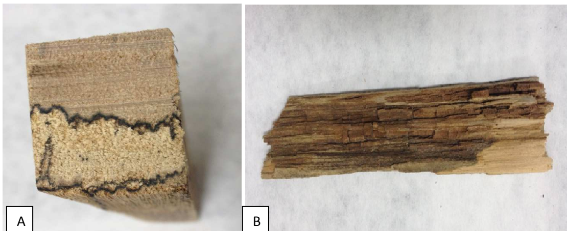
Figura 2: Características da madeira atacada por fungo de podridão branca (A); Características da madeira atacada por fungo de podridão parda (B).
