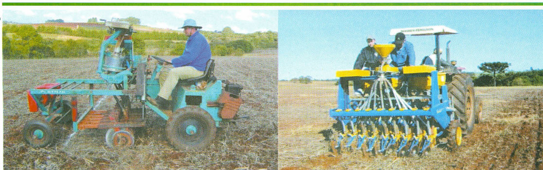
Figura 2. Semeadura de semente genética de trigo em linhas individualizadas (esquerda) e em parcelas massais (direita).
