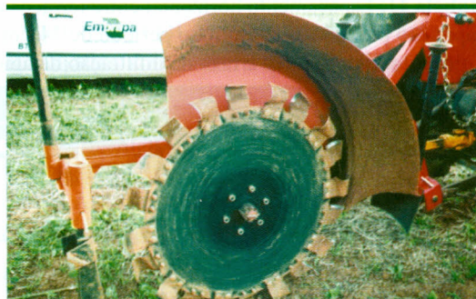
Figura 3. Implemento agrícola denominado de valetadora rotativa, empregado na construção do vertical mulching .
