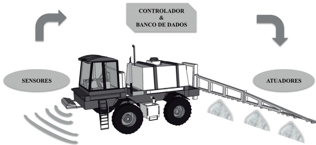
Figura 1. Sistema de sensoriamento e aplicação *On-The-Go*.
