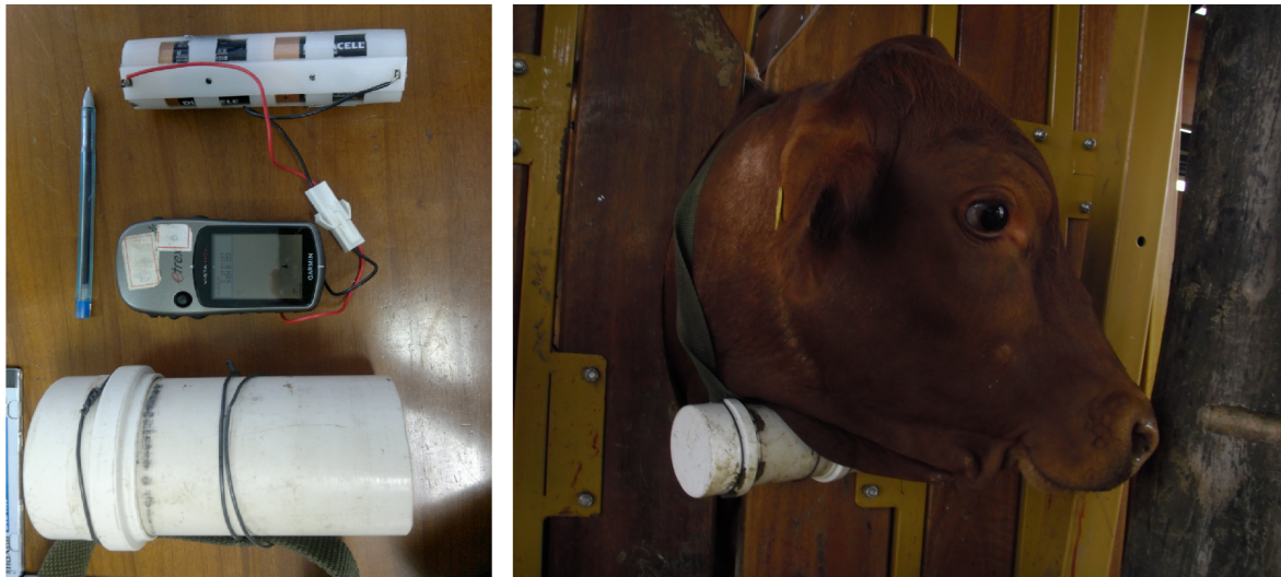
FIGURA 2: Detalhes da montagem do equipamento e fixação no animal.
